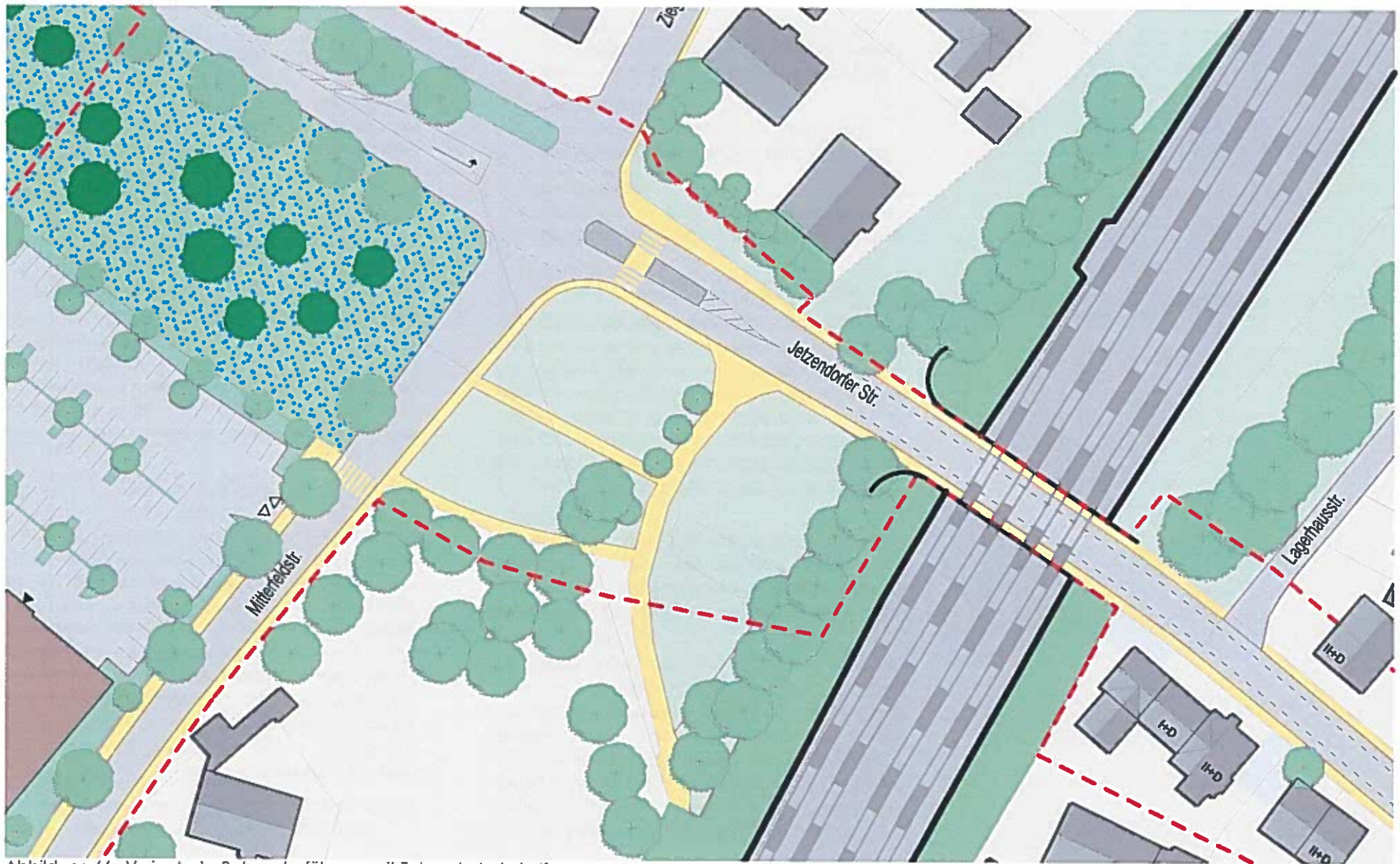
Abbildung 66: Variante I - Bahnunterführung mit Fahrradschutzstreifen
