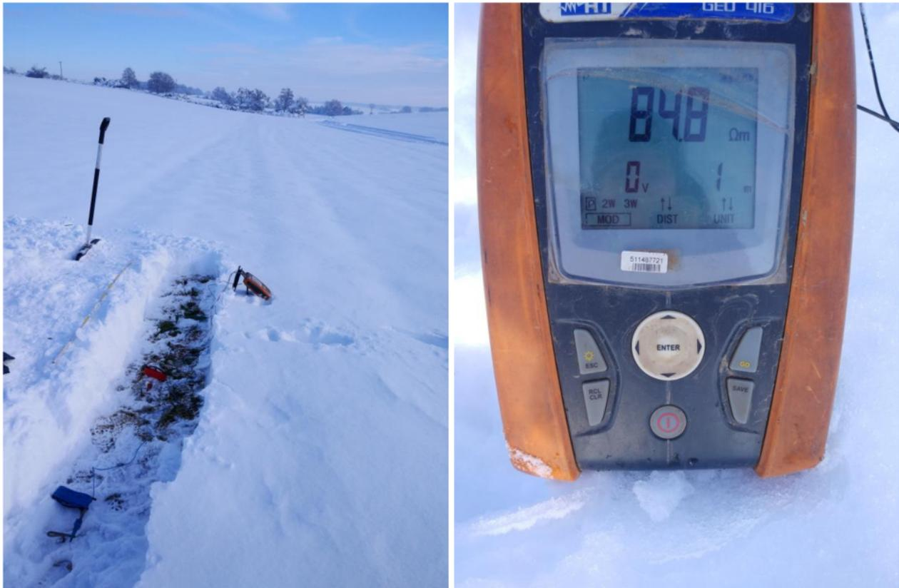
**Abbildung 3** - Messung der elektrischen Leitfähigkeit vor Ort beispielhaft am Punkt RKS 3.
