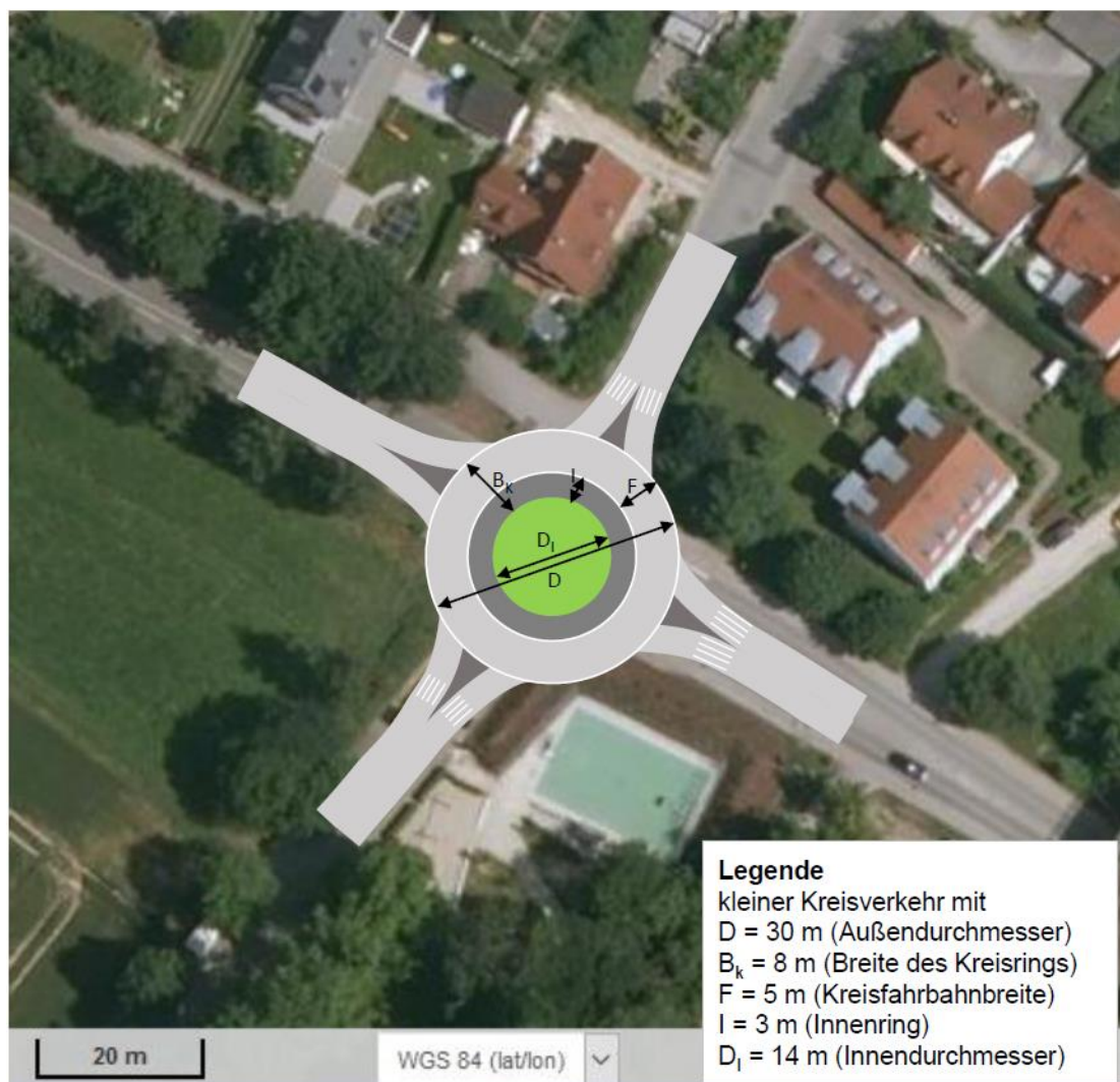
Abbildung 9: konzeptionelle Darstellung eines 4-armigen Kreisverkehrs am KP Mitterfeldstr. / Ziegeleistr. (Hintergrundquelle: Bayern Atlas)
