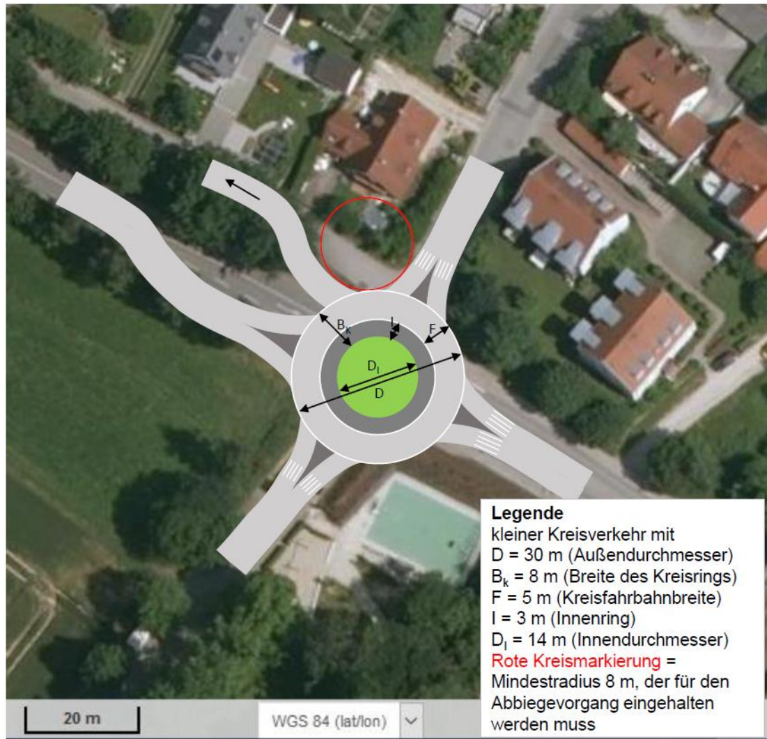
Abbildung 10: konzeptionelle Darstellung eines 5-armigen Kreisverkehrs am KP Mitterfeldstr. / Jetzendorfer Str. / Ziegeleistr. (Hintergrundquelle: Bayern Atlas)
