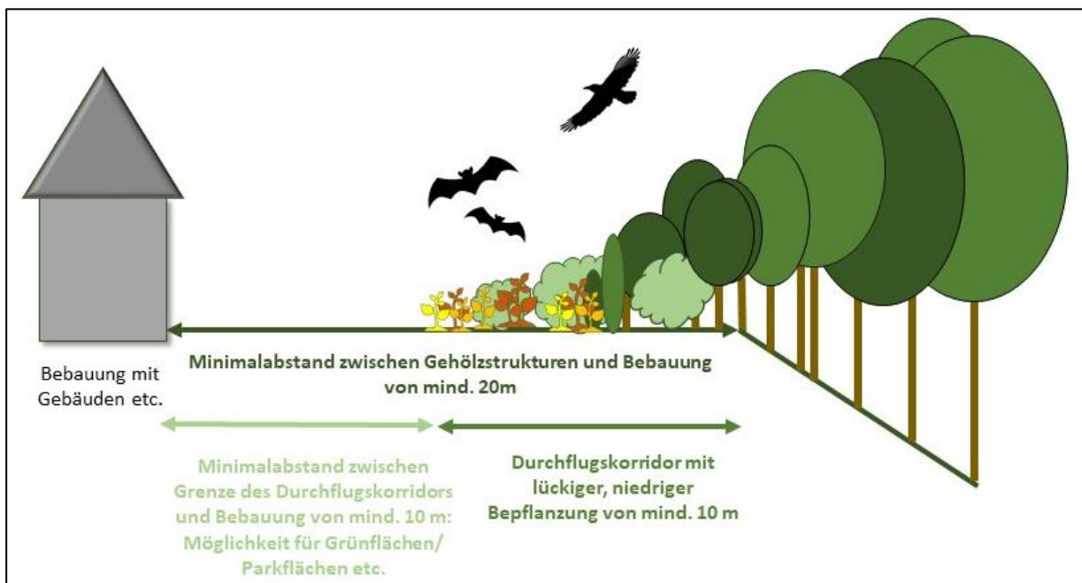
Abbildung 5: Schematische Darstellung des Durchflugkorridors und Minimalabstandes zwischen nordöstlicher Gehölzreihe und zukünftiger Bebauung (vgl. M2; Mühl 2019)
