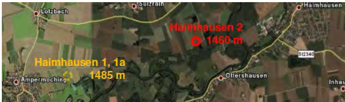
Abbildung 33: Geothermische Probebohrungen in Haimhausen (Quelle: GeTeS)
