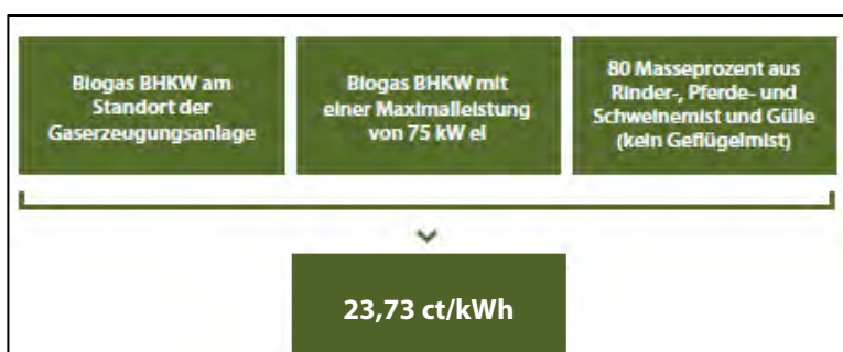
EEG-Einspeisevergütung (anzulegender Wert) von Gülle-Biogasanlagen (Quelle: Senergie GmbH, Vergütung nach EEG 2014 angepasst)
